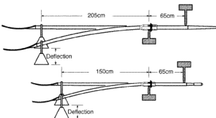
Измерения жесткости производятся для стандартной длины цевья, т.к. более длинное цевье будет более гибким, чем более короткое той же жесткости.
